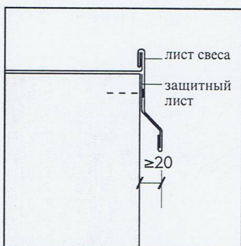
Рис. 44 Торцевой или верхний свес. Масштаб 1:5.
